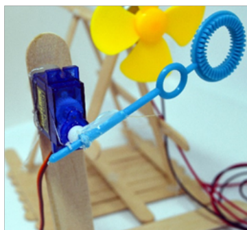
Tubo de plástico pegado al motor servo.
